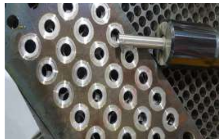
After back spot-faced test (hole \Phi 13.1 \rightarrow spot faced \Phi 26.2 ) 백 페이싱 테스트후의 사진 (홀 \Phi 13.1 , 페이싱 \Phi 26.2 )
