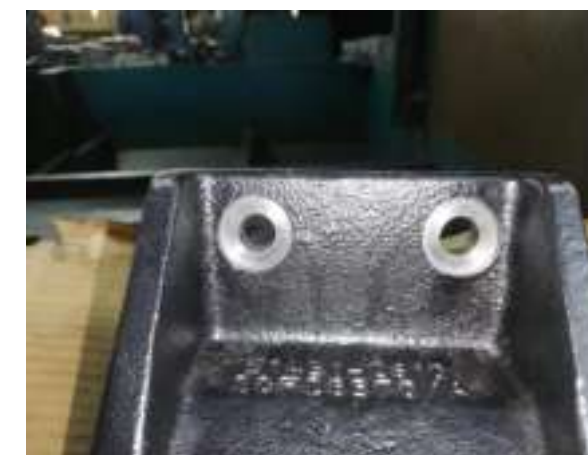
After back spot-faced test on forged steel (hole \Phi 13.1 \rightarrow spot faced \Phi 26.2 ) 단조강에 백 페이싱 작업후 사진 (홀 \Phi 13.1 , 페이싱 \Phi 26.2 )
