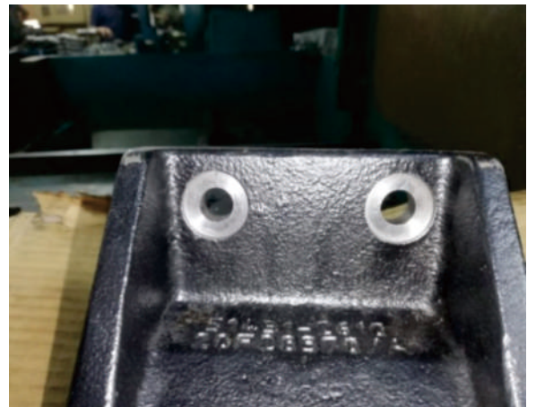
After back spot-faced test on forged steel (hole \Phi 13.1 spot faced \Phi 26.2 ) 단조강에 백 페이싱 작업후 사진 (홀 \Phi 13.1 , 페이싱 \Phi 26.2 )
