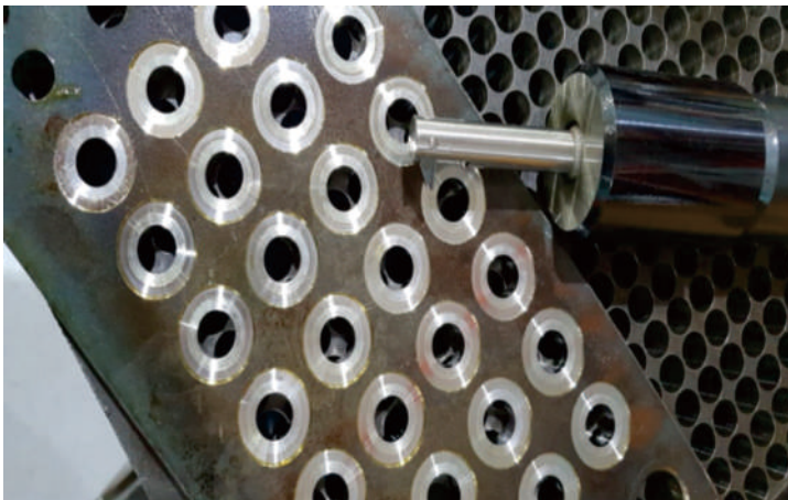
After back spot-faced test (hole \Phi 13.1 spot faced \Phi 26.2 ) 백 페이싱 테스트후의 사진 (홀 \Phi 13.1 , 페이싱 \Phi 26.2 )
